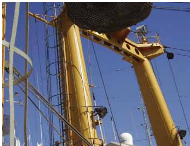
Траулер «Владивосток». Мачты и стрелы окрашены экипажем однокомпонентными алкид-уретановыми и алкидными материалами Гамма-АУР-067Т и ПФ-167
