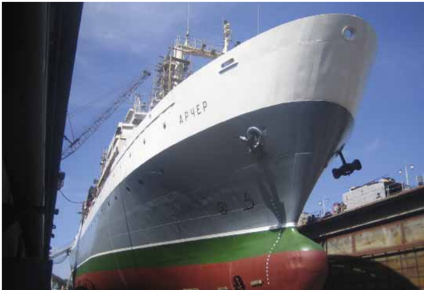
Траулер «Арчер». Окраска подводного борта, пояса переменных ватерлиний, надводного борта и открытых палуб
