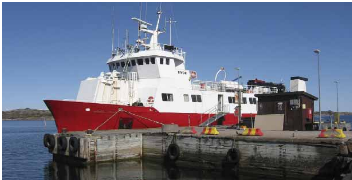
Грузо-пассажирское судно «Eivor». Надводный борт окрашен однокомпонентными алкидными материалами — грунтовка Темапрайм ЕЕ + финишная краска Темалак ФД 80
