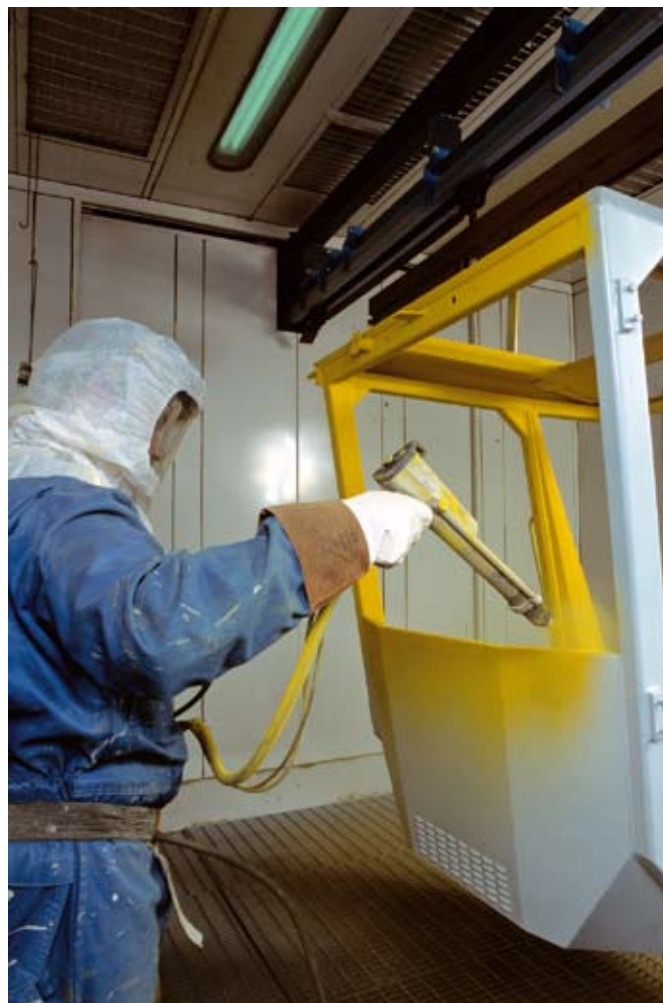
Рис. 3. Применение водоразбавляемых красок не требует сколько-нибудь больших затрат на приспособление уже известного окрасочного оборудования. Нанесение грунтовки на кабину «Wille» Vilakone Oy, Финляндия.
