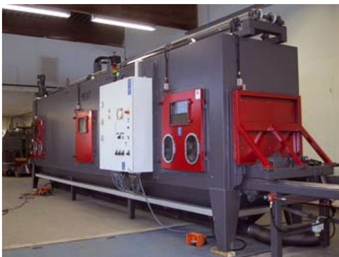
Рис. 4. Машина для автоматической воздушной очистки компании Finnblast Oy окрашена водоразбавляемой эпоксидной краской Fontecoat EP 50.
